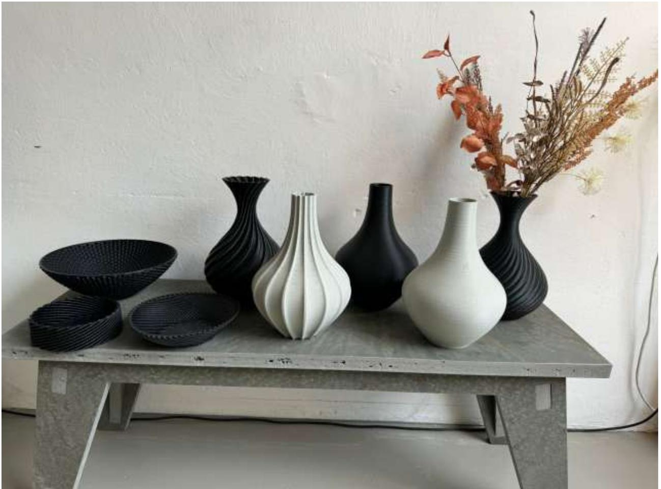
Die 3D-Druckerzeugnisse stehen auf einem Tisch aus Mischkunststoffplatten, welche ebenfalls aus Abfallkunststoffe hergestellt sind.
